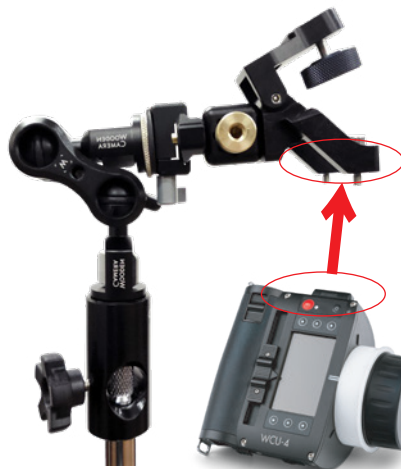
WCU-4 のネジにブラケットを取り付ける
